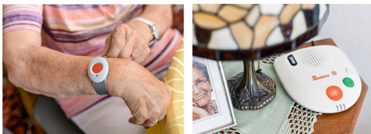
Funksender und Basisstation können über eine Strecke von bis zu 150 Metern miteinander kommunizieren. Akkus sorgen für einen störungsfreien Betrieb auch bei Stromausfall
